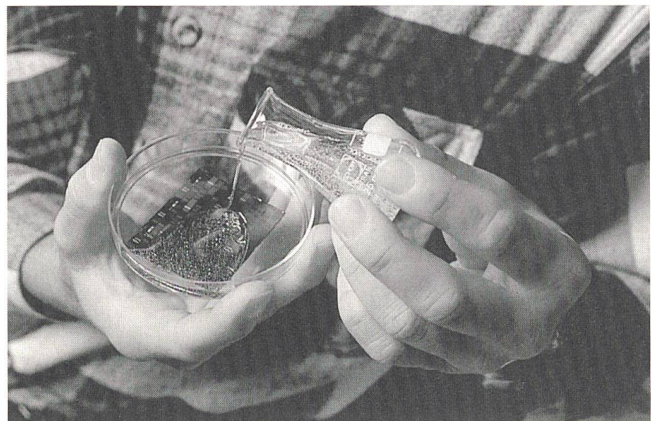
Ein «Lichtstempel» entsteht durch Übergießen des «Masters» aus Silizium mit dem Polymer, das sich anschliessend verfestigt.
