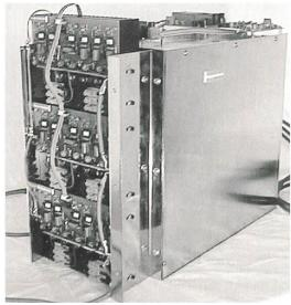
gefertigt sind, haben Entladewiderstände. Wenn die Entladung besonders schnell erfolgen muss, beispielsweise bei mehreren Abgleichen pro Minute, dann kommen auch Entladedrosseln zum Einsatz. Mit diesen Massnahmen wird gewährleistet, dass die Spannung an den Kondensatoren beim erneuten Zuschalten auf einen für die Schaltelemente verträglichen Wert gesunken ist. Diese Kondensatorbatterien sind beim Vorhandensein von nichtlinearen Verbrauchern natürlich auch verdrosselt lieferbar.
