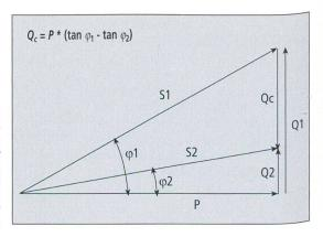
Hier schafft die Reihenschaltung einer Drosselspule zum Kompensationskondensator Abhilfe. Eine so verdrosselte Kondensatorbatterie weist eine Reihenresonanzfrequenz auf, die auf die Oberschwingungsfrequenz abgestimmt ist und die Parallelresonanzstelle in unkritische Bereiche verschiebt. Die Reihenresonanzkreise können beispielsweise mit den Informationen, die eine Netzanalyse liefert, auf die kritischen Oberschwingungsfrequenzen abgestimmt werden.
