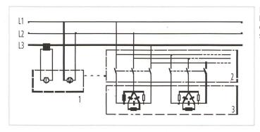
Bild 2 Prinzipschaltbild einer Kompensationsanlage.
