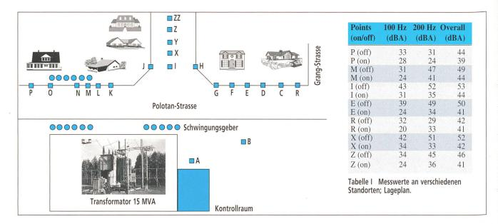
Der nächste Schritt ist die Untersuchung des Transformatorkessels als Geräuschquelle. Diese erfolgt durch Beschleunigungsmessungen und Aufzeichnen der Eigenschwingungsform der Kesselwand. Die Messungen am Standort nehmen im Normalfall weniger als eine Woche in Anspruch. Durch die Beschleunigungsmessungen werden die Schalleistung und die Geräuschintensität an verschiedenen Abschnitten des Transformatorkessels ermittelt.
