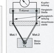
Bild 2 Temperaturmessung unter Verwendung eines Thermoelementes
