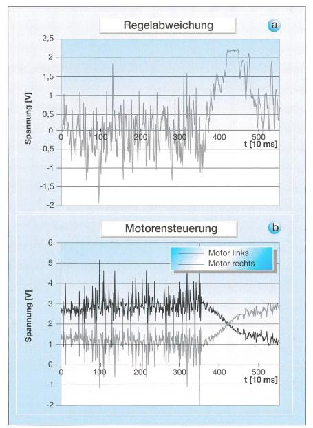
Bild 2 Regelabweichung und Motorensteuerung beim Übergang von einem Radius von 50 cm auf 30 cm (1 V entspricht einer Regelabweichung von 1,3 mm)
