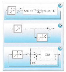
Bild 5 Zur Stabilitätsuntersuchung des Regelkreises mit Stellanschlägen
