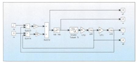
Bild 3 Die Positionsregelung (als Simulink-Modell)
