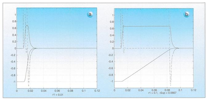
Bild 8 Die Führungssprungantworten mit Geschwindigkeitsbegrenzung auf konstanten Soll-Wert, für  $r_1 = 0.01$  (a) und  $r_2 = 0.1$  (b)
