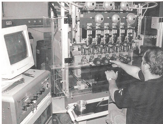
Modernste 6-Spindel-Wickelautomaten im Einsatz bei der w. frei ag.
