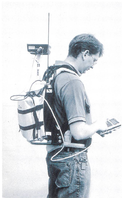
Bild 3 DGNSS im praktischen Einsatz Erfassung von Positionen und Zusatzattributen
