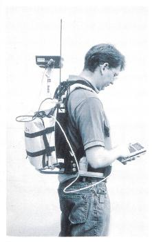
Bild 3 DGNSS im praktischen Einsatz Erfassung von Positionen und Zusatzattributen
