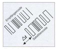
Bild 2 Distanzbestimmung durch Laufzeitmessung
