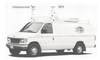
Bild 3 Visat-Messfahrzeug [4]
