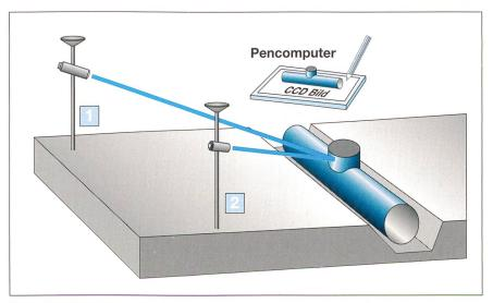
Bild 4 GPS-EDM-CCD-Kamera-Kombination
