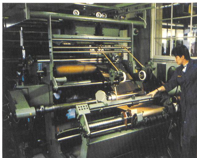
Fertigung von US-Bandwicklungen
