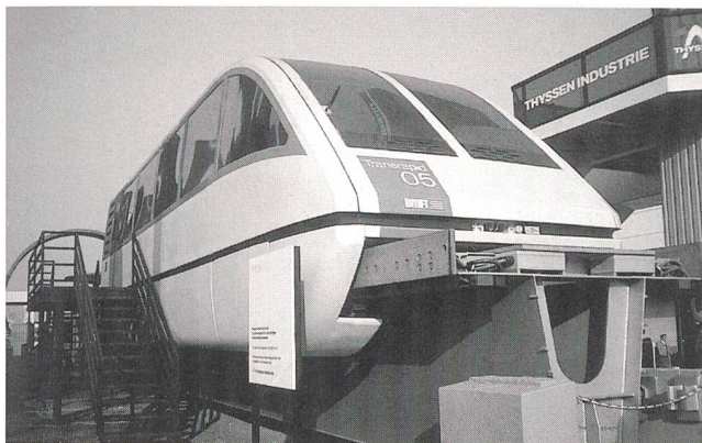
Transrapid mit magnetischem Trag- und Führungssystem.
