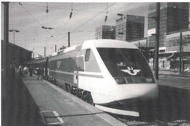
Schwedischer X2000 mit integrierter Neigetechnik.
