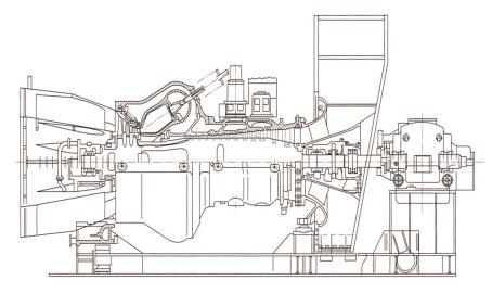
Bild 2 Verglichen mit der GT8C konnte die Bauhöhe der GT8C2 von 7,9 m auf 5,2 m vermindert werden. Durch die Verwendung eines im Werk hergestellten, weniger platzaufwendigen Luftansaugstutzens aus Stahl wurde es möglich, das Getriebe im Gasturbinenblock zu montieren.
