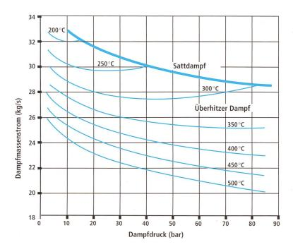
Bild 3 Dampferzeugungskurven in Abhängigkeit der Dampfbedingungen bei ISO-Bedingungen.
