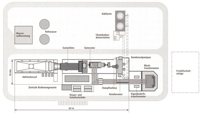
Bild 4 Anordnung eines einwelligen Kombikraftwerksblocks für Freiluftaufstellung. Der Abdampf aus der Dampfturbine fliesst direkt in den auf Kote Null montierten Kondensator. Die Rückkühlung erfolgt durch einen Nass- oder Hybridkühlturm.
