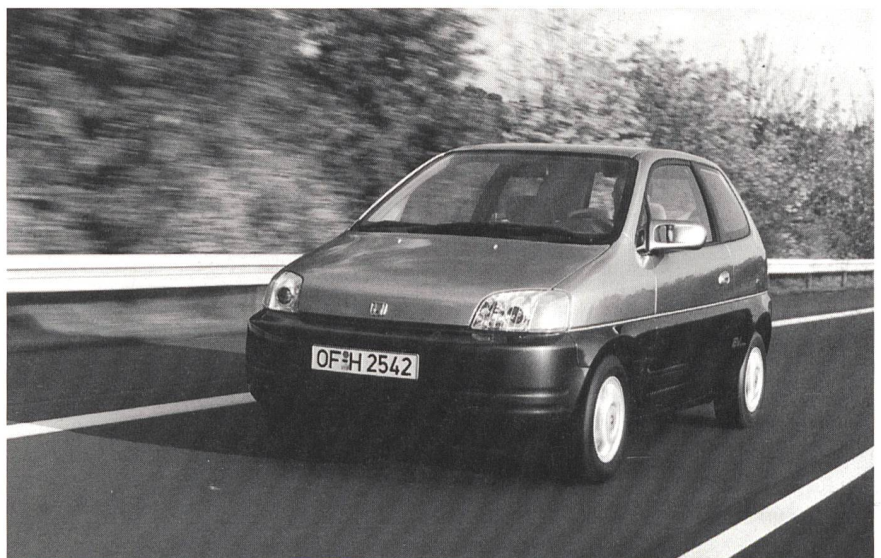
2 Der Honda EV plus verkörpert eine neue Generation von Elektrofahrzeugen. Noch ist er zwar nicht serienmässig erhältlich, seine Fahrleistungen – Höchstgeschwindigkeit 130 km/h und Reichweite bis etwa 140 km – überzeugen jedoch auf Anhieb.
