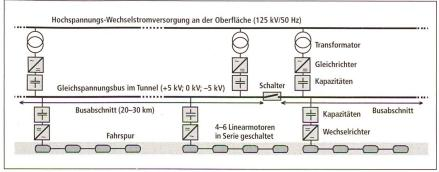
Bild 5 Topologie der Energieversorgung im Tunnel.
