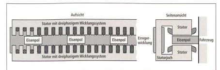
Bild 3 Aufbau des homopolaren synchronen Linearmotors (Auf- und Seitenansicht).
