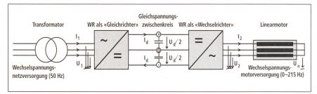
Bild 4 Topologie des Gleichspannungs-Frequenzumrichters.
