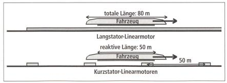
Bild 2 Zwei verschiedene Konfigurationen des Linearmotors.
