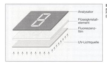
Bild 9 Schema einer photolumineszierenden Flüssigkristallanzeige (ETH Zürich)
