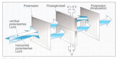
Bild 1 Flüssigkristallanzeige
