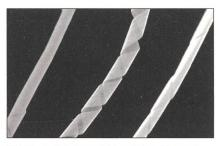
Bild 12 Helligkeitsvergleich zwischen Filmen mit Sensibilisator (links), mit fluoreszierendem Polymer (Mitte) und mit beiden Molekülsorten (rechts)
