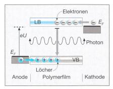
Bild 6 Funktionsprinzip einer halbleitenden Polymer-LED
