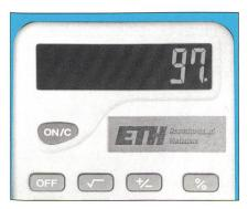
Bild 10 Einfarbige photolumineszierende Taschenrechneranzeige (ETH Zürich)
