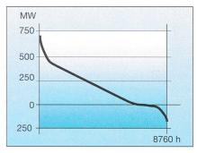
Bild 1 Jahresdauerlinie der Nutzung eines 380-kV-Stromkreises
