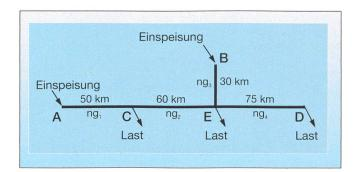
Bild 3 Leitungsflüsse für Fall 1 und Fall 2
