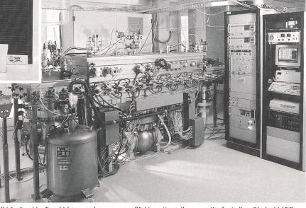
Bild 2 Durchlaufbeschichtungsanlage zur grossflächigen Herstellung von Kupfer-Indium-Diselenid (CIS) mit thermischer Verdampfung im Vakuum (Bild ZSW).
