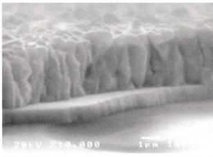
ZnO (0,5 μm) CdS (0,05 μm)
