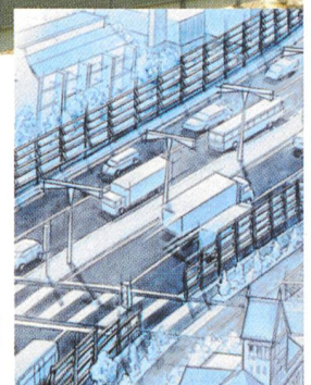
Hochabsorbierende Schallschutzwand mit Grosslaminaten von Creaglas und Zellen von Siemens Solar. Werkbild FabriSolar AG
