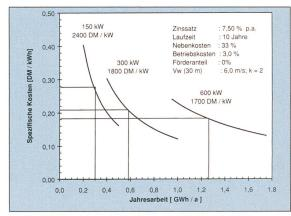
Bild 1 Stromgestehungskosten unterschiedlicher Windkraftanlagen-Leistungsklassen in Deutschland<sup>4</sup>.
