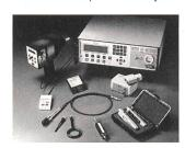
ESD- und EFT/Burst-EMV-Immunitätsprüfsystem
