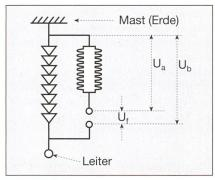
Bild 1 Ableiter mit Funkenstrecke parallel zur Isolation
