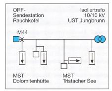
Bild 3 Einbauorte der Ableitzähler
