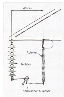
Bild 2 Ableiterinstallation mit Soll-Bruchstelle
