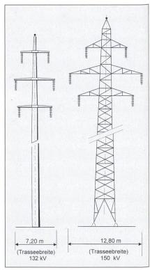
Bild 7 Trasseebreiten ein- und zweistieliger Hochspannungsmaste
