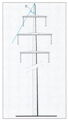
Bild 5 Der Erdseilschutzwinkel
