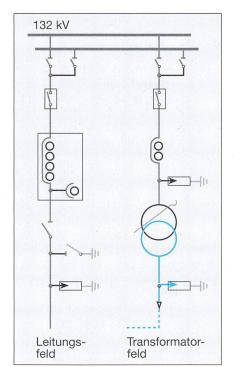
Bild 3 Einbauorte der Überspannungsableiter in einer Freiluftanlage
