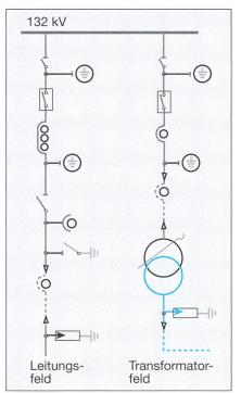
Bild 4 Einbauorte der Überspannungsableiter in einer SF<sub>6</sub>-Anlage
