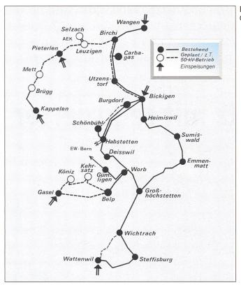
Bild 2 Das 132-kV-Netz der BKW
