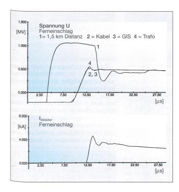
Bild 4 Ferneinschlag auf der Freileitung chenmodelle, zum Beispiel an die Modellierung der Leitung inklusive des Erdseils, der Masten, des Portals und der Ableiter. Ein weiteres Problem ist die Wahl realistischer Eingabeparameter, etwa der Blitzstromamplitude und -form,
