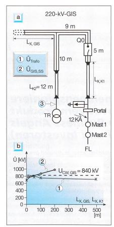
Bild 8 Einfluss verschiedener Parameter bei Direkteinschlag
