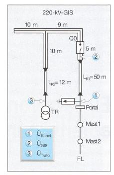
Bild 2 Reduziertes Anlagenschema
