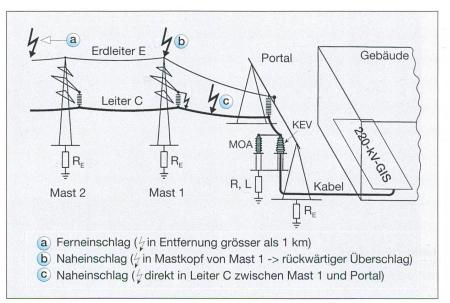
Bild 3 Simulation der Blitzeinschläge
