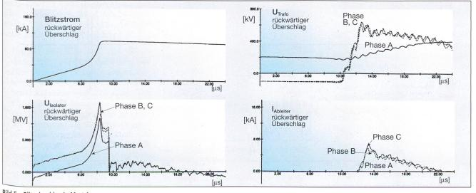
Bild 5 Blitzeinschlag in Mast 1
