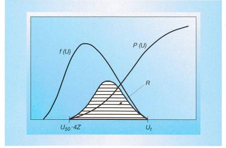
Bild 3 Zur Berechnung des Fehlerrisikos R
