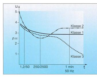
Bild 2 Abhängigkeit der relativen Stehspannungen der drei typischen Isolierklassen von der Beanspruchungsdauer Isolierklasse 1: Gase Isolierklasse 2: Luft
