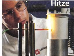
Selbstverlöschendes Material. Bei 850° C geprüft, für die Sicherheit im Betrieb
