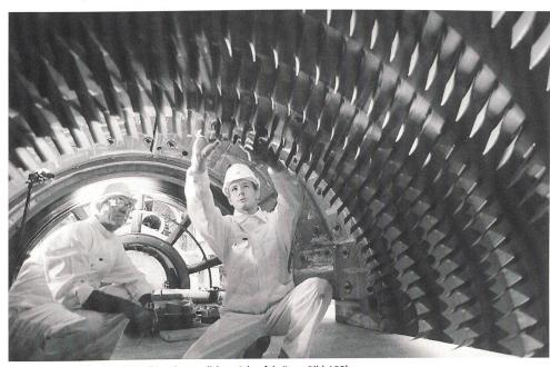
Moderne Gasturbine Typ GT26 (hier der Verdichter-Schaufelträger; Bild ABB).
