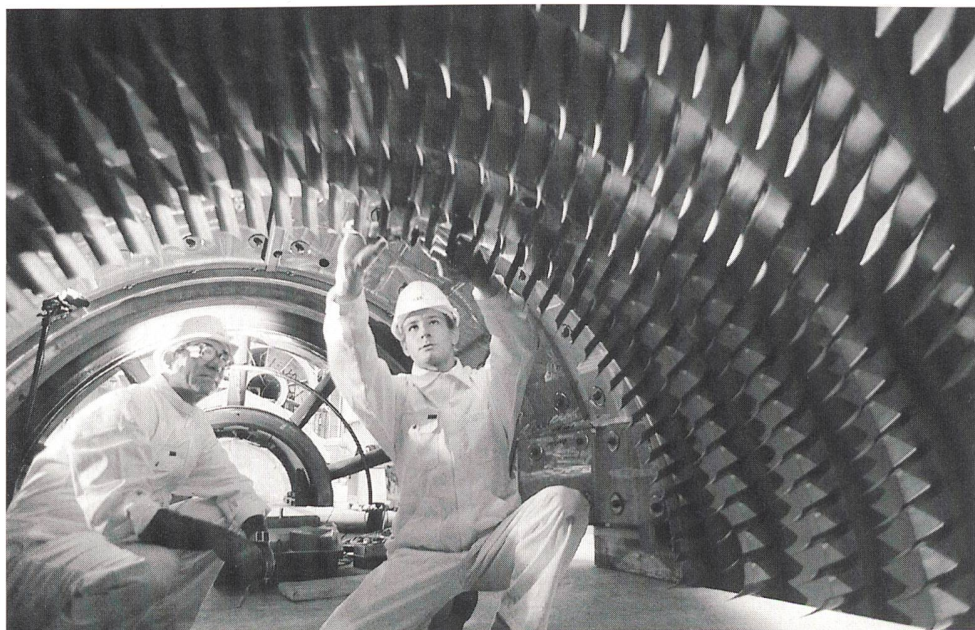
Moderne Gasturbine Typ GT26 (hier der Verdichter-Schaufelträger; Bild ABB).
