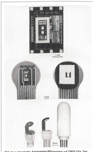
Bild oben: Integriertes Anemometer-Mikrosystem auf CMOS-Chip. Den Strömungssensor umgibt ein Rahmen, der zur lückenlosen Verpackung der Messvorrichtung dient. Auf der rechten Seite des Rahmens befindet sich die Auswertschaltung.
