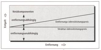
Struktur der Durchleitungsentgelte im Deutschen Übertragungsnetz.
