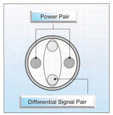
Bild 10 USB-Kabel-Querschnitt
