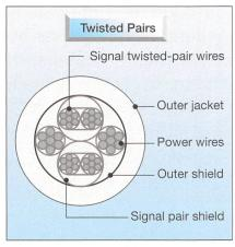
Bild 3 IEEE-1394-Kabel-Querschnitt
