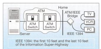
Bild 6 Mögliche Anwendung einer IEEE-1394-ATM-Brücke
