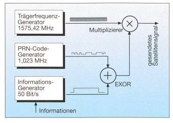
Bild 7 Vereinfachtes Satellitenblockschema
