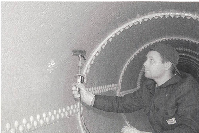
Bild 9 Überprüfung der Porenfreiheit mit Hochspannungsdetektor.
