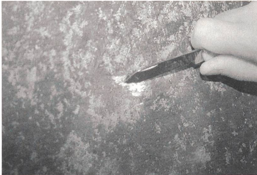
Bild 3 Die alte Beschichtung war mit einem Messer leicht entfernbar.
