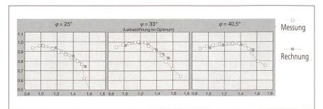
Bild 3 Relativer Turbinenwirkungsgrad für verschiedene Leitradöffnungen  $\phi$  (als Funktion der spezifischen Umfangsgeschwindigkeit Ku).
