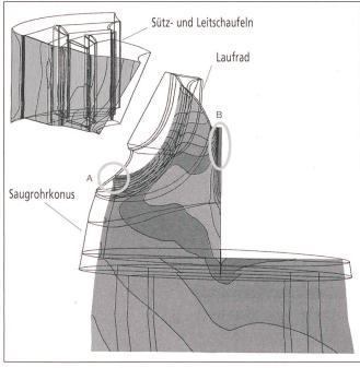
Bild 5 Druckverteilung in einem Längsschnitt durch den Strömungskanal.
