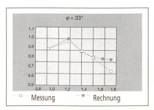
Bild 4 Relativer Saugrohr-Wirkungsgrad bei der Leitradöffnung  $\varphi$  = 33° (als Funktion von  $K_u$ ).
