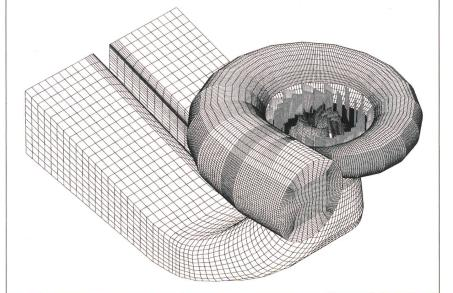
Bild 1 Erstmals konnte eine komplette Francisturbine rechnerisch simuliert werden. Hier das Rechennetz mit Spirale, Stützschaufelring, Leitschaufeln, Laufrad und Saugrohr (500 000 Knoten).
