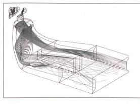
Bild 7 Stromlinien im Saugrohr bei Betrieb leicht ausserhalb des Bestpunktes (Wirbel im vorderen Diffusorkanal).
