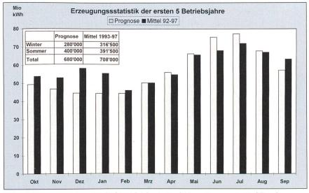
Bild 7 Jahreserzeugung der ersten fünf Betriebsjahre im Vergleich zur Prognose. Positiv fällt auf, dass die Jahreserzeugung leicht über der Prognose liegt und der Anteil Winterenergie deutlich höher ist.
