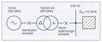
Bild 1 Einpoliges Schema für die Untersuchung von Fehlsynchronisationen
