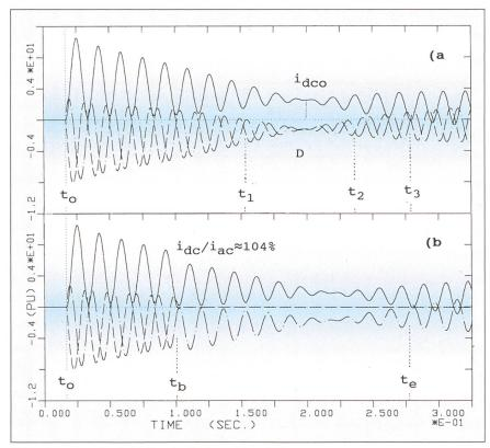
Bild 2 Generatorströme bei Fehlsynchronisation mit  $\delta_0$  = +120°
