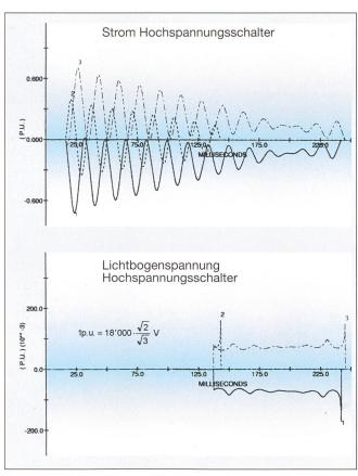
Bild 8 Fehlsynchronisation bei  $\delta_0$  = +120° und Kontaktrennung des Hochspannungsschalters 120 ms nach Fehlereintritt
