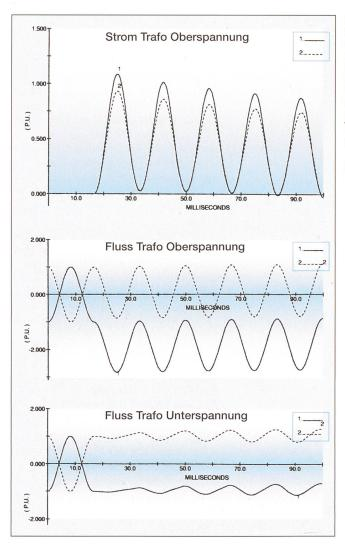
Bild 10 Maximaler Strom in OS-Wicklung des Blocktransformators und entsprechender Fluss in OS- und US-Wicklung bei Fehlsynchronisation mit  $\delta_0$  = 180° entsprechend Bild 1, aber  $S_{k^*}$  = 20 GVA, Trafo YNy0
