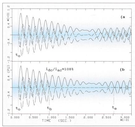
Bild 3 Generatorströme bei Fehlsynchronisation mit  $\delta_0 = +120^{\circ}$
