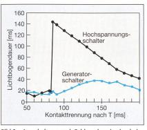
Bild 9 Ausschaltung nach Fehlsynchronisation bei  $\delta_0$  = +120°
