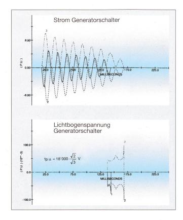
Bild 7 Fehlsynchronisation bei  $\delta_0$  = +120° und Kontakttrennung des Generatorschalters 120 ms nach Fehlereintritt
