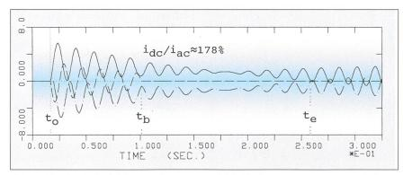
Bild 6 Fehlsynchronisation bei  $\delta_0$  = +60°, Phase B symmetrisch (Schlupf = 0, Erregerspannung = const.) mit Ausschaltung in Phase B nach rund 80 ms
