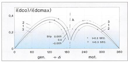
Bild 4 Relative Gleichstromkomponente  $i_{dc0}/i_{dcmax}$  bei  $\delta = 0$  in Funktion des Anfangsfehlwinkels  $\delta_0$
