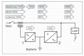
Bild 7 Energiefluss bei 15% Netzüberspannung
