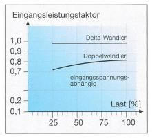
Bild 10 Eingangsleistungsfaktor in Abhängigkeit der Last
