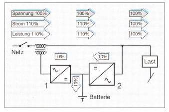
Bild 8 Energiefluss bei Netznennspannung und Batterieladung
