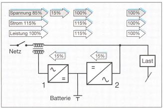
Bild 6 Energiefluss bei 15% Netzunterspannung
