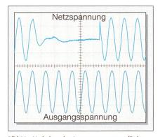
Bild 11 Verhalten der Ausgangsspannung (Delta-Wandler) bei kurzzeitigem Netzausfall
