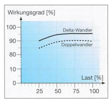
Bild 9 Wirkungsgradvergleich in Abhängigkeit der Last
