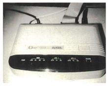
Bild 4 ISDN-Adapter für Anschluss an Personalcomputer, in Handhabung und Aussehen ähnlich wie Modem
