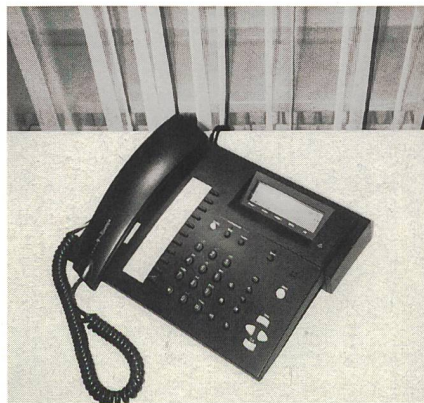
Bild 2 Typisches ISDN-Telefon mit Komfortmerkmalen wie Display, Nummernspeicher, automatischer Wiederwahl usw.
