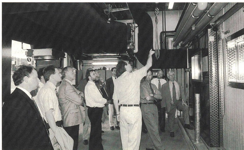
Prüfzentrum von internationaler Bedeutung: André Montani erläutert Besuchern aus Deutschland den Aufbau der Prüfeinrichtungen für Wärmepumpen. Rechts die Kaltzelle der Klimakammer.
