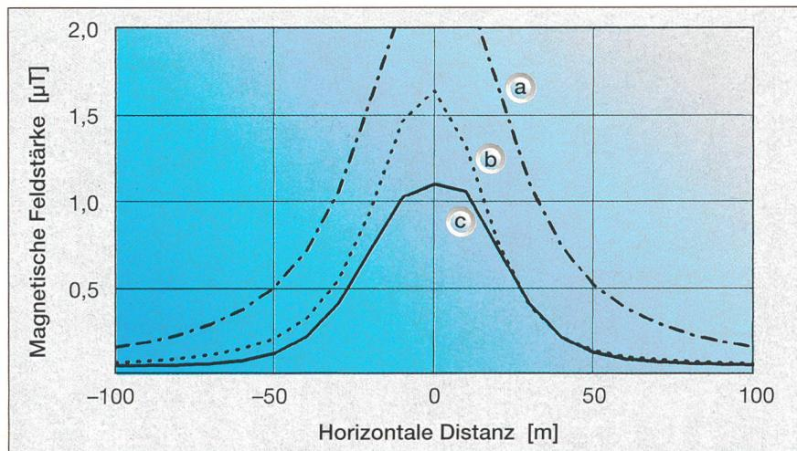
Bild 7 Magnetfeld einer HS-Leitung, gemessen auf Bodenhöhe
