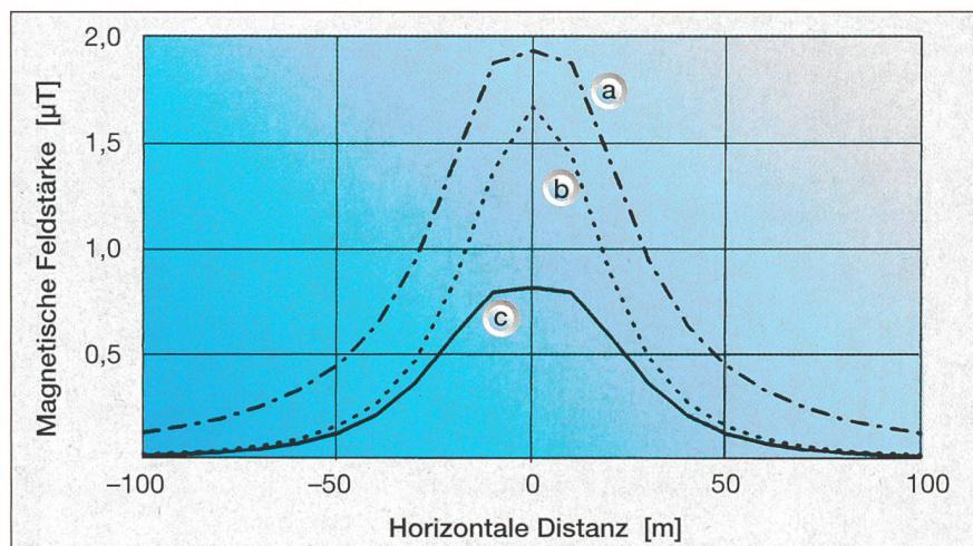
Bild 2 Magnetfeld einer HS-Leitung, gemessen auf Bodenhöhe
