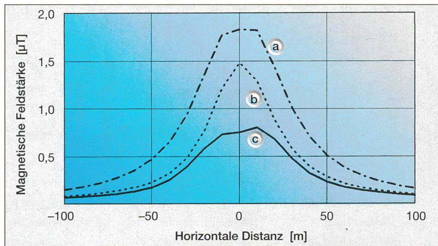
Bild 6 Magnetfeld einer HS-Leitung, gemessen auf Bodenhöhe
