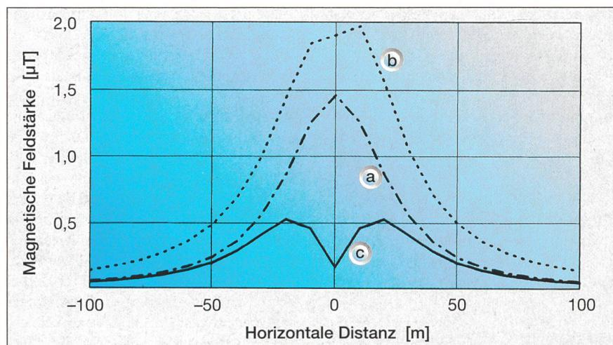
Bild 3 Magnetfeld einer HS-Leitung, gemessen auf Bodenhöhe
