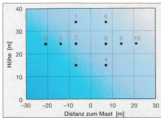
Bild 4 Für die Modellrechnungen verwendetes Mastbild einer 10-Leiter-Freileitung
