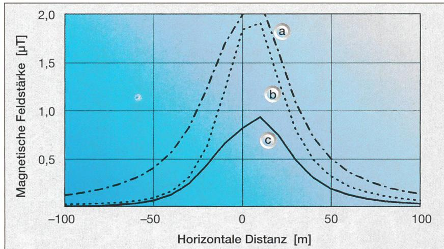
Bild 5 Magnetfeld einer HS-Leitung, gemessen auf Bodenhöhe
