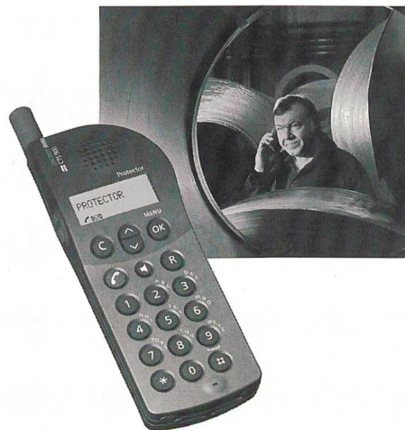
Taschenkommunikator für Personenüberwachung und Schnurlos-Telefonie (Bild ascom).
