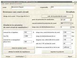
Fig. 9 Dimensionnement des conducteurs, résistance au courant de court-circuit
