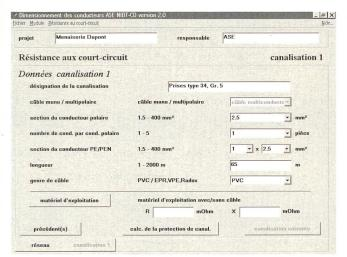
Fig. 8 Dimensionnement des conducteurs, données relatives à la canalisation
