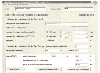
Fig. 11 Dimensionnement des conducteurs, chute de tension et perte de puissance
