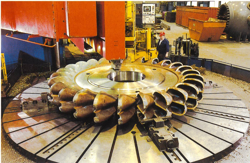
Bild 2 Fertigung eines der drei Peltonräder (je 423 MW) im Werk Ravensburg.
