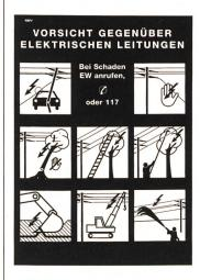
Eine Warntafel «Vorsicht gegenüber elektrischen Leitungen» in Form von Piktogrammen wurde in Zusammenarbeit mit Elektrizitätswerken erarbeitet. Sie ist für den Anschlag an elektrischen Verteilanlagen und an öffentlichen Anschlagbrettern in ländlichen Gebieten vorgesehen. Diese Warntafel hat die Grösse A3 und ist in eloxiertem Aluminium in den Farben Silber/Blau für Aussenaufstellung ausgeführt.
