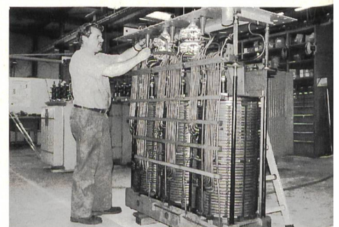
Die IBA Servicebetriebe führen Revisions- und Instandhaltungsarbeiten an Transformatoren durch.
