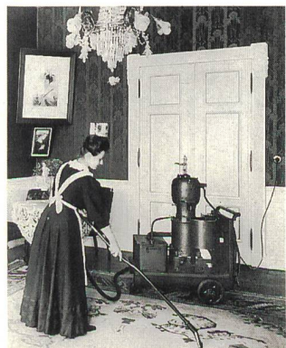
Bild 6 «Entstäubungspumpe», ein Staubsauger aus dem Jahr 1906.
