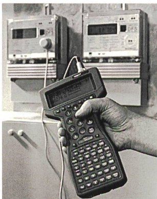
Elektronischer Zähler mit Ablesekopf und Ablesegerät Husky
