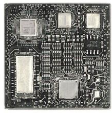
Bild 1 Kompletter 16-Bit-Mikroprozessor mit Flash EPROM, RAM und Interface-Logik auf einem Multichip-Modul von 40×40 mm mit 300 Anschlüssen<sup>1</sup>
