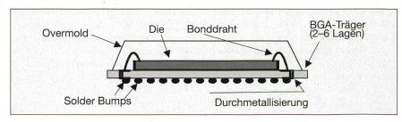
Bild 5 Aufbau eines BGA(Ball Grid Array)-Gehäuses
