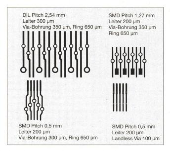
Bild 9 Grössenvergleich verschiedener Leiterplattentechnologien
