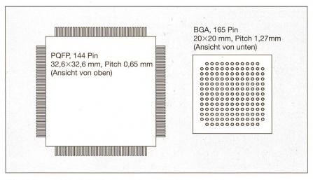
Bild 4 Grössenvergleich eines 144-Pin-QFP mit einem 165-Pin-BGA
