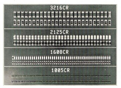
Bild 8 SMD-Widerstände mit verschiedenen Baugrössen
