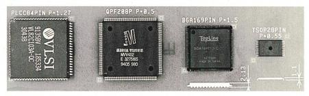
Bild 6 Grössenvergleich von SMD-Gehäusen<sup>3</sup>
