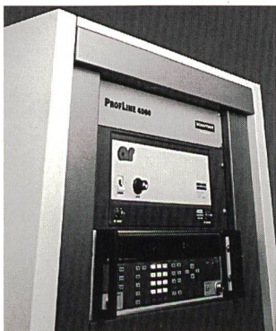
Das PC-gestützte EMV-Testsystem Proflin 4000 gemäss IEC 1000-4-6
