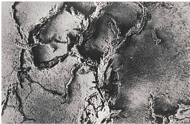
Bild 4 Grabende Erosion in einem SR-HTV
