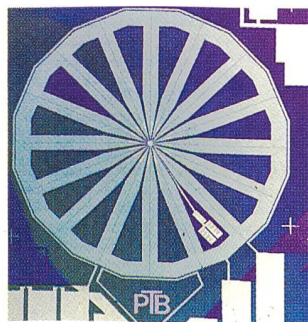
HTS-Squid der PTB (Durchmesser: 7 mm)
