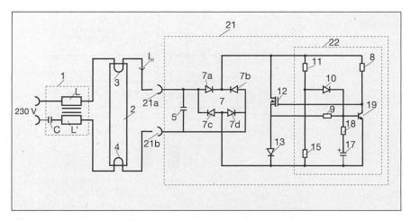
Bild 5 Gesamtschaltung mit detailliertem Schema des elektronischen Universalstarters
