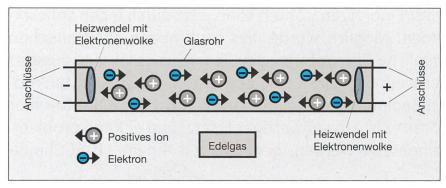
Bild 1 Gas einer Fluoreszenzröhre im ionisierten Zustand
