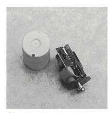
Bild 6 Fertig aufgebauter elektronischer Zweipol-Starter
