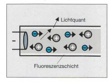
Bild 2 Ultraviolettes Licht wird an der Fluoreszenzschicht in sichtbares Licht umgewandelt.
