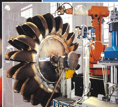
▲ Fertigung eines Pelton- Laufrades im MicroGuss- Verfahren
